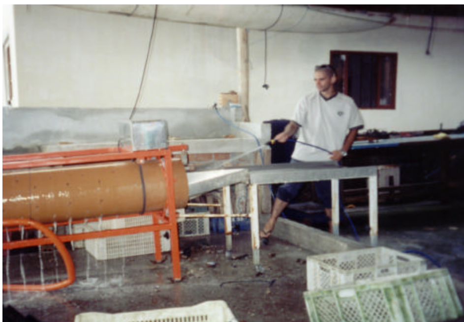
Figura 5 : Máquina para limpar mariscos e ostras, fabricada em Ribeirão da Ilha pelo técnico Andrey Ferreira Foto: Clarete Oliveira Manganhotto
